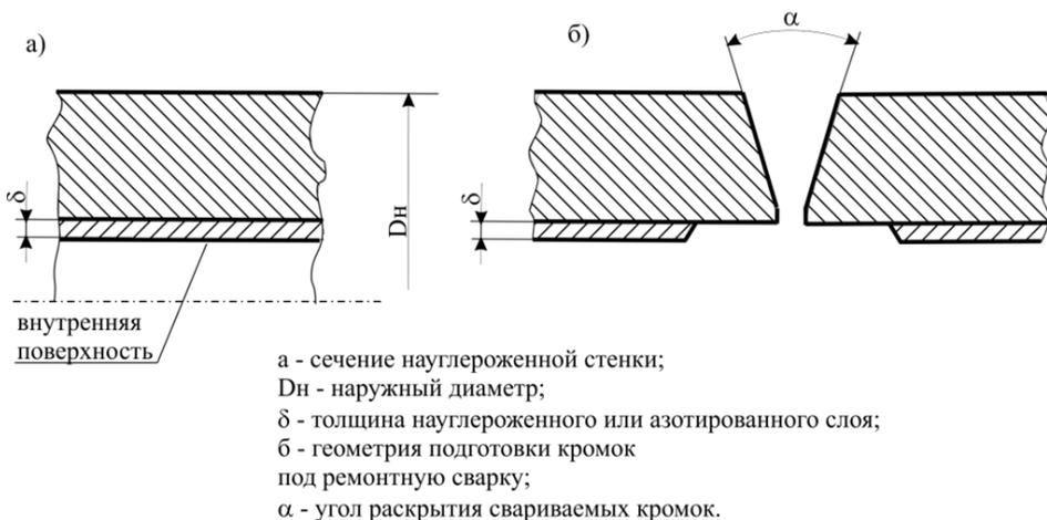
Рис. 2. Характер науглероживания и азотирования трубопровода или корпуса аппарата
