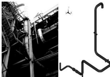
Рис. 2. Конечноэлементная модель трубопровода
