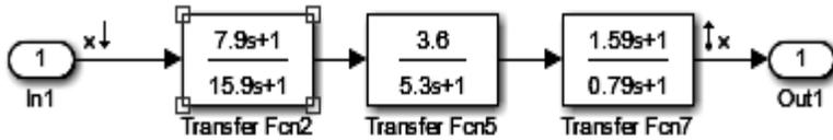
Рис. 2. Передаточная функция объекта управления следящей системы
