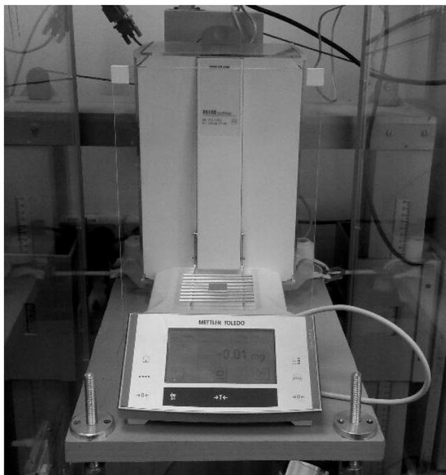
Рис. 1. Прецизионные весы фирмы Mentor Toledo
