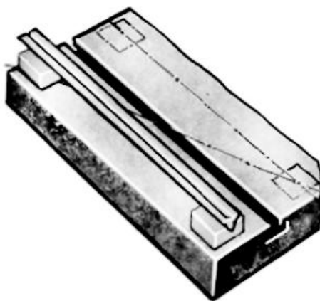
Рис. 3. Схема проверки плоскостности рабочей поверхности стола
