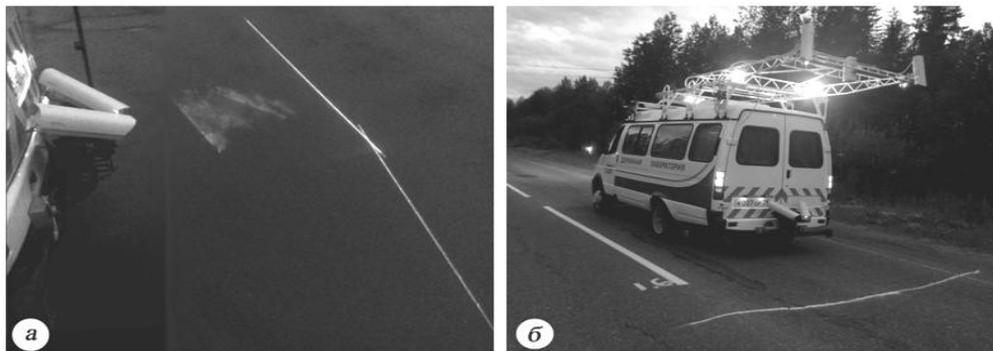
Рис. 1. Развертка профиля колеи: а – на ровном покрытии, б – на покрытии с наличием колейности
