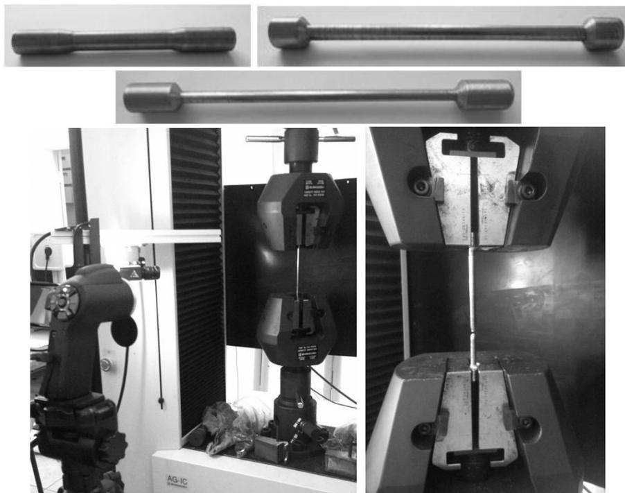
Рис. 3. Образцы из болтов M20, M24, M30. Испытание на растяжение на машине Shimadzuag 300кН
