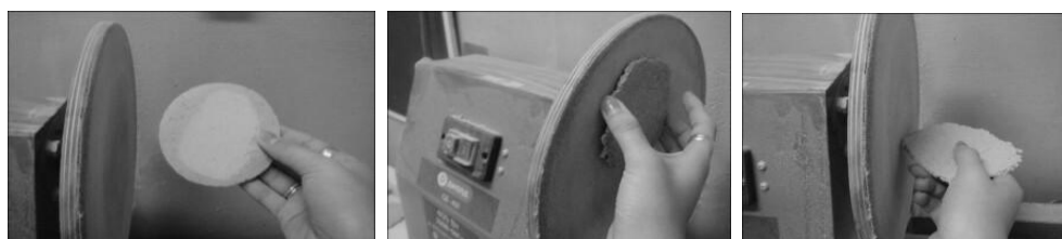
Рис. 5. Процесс формирования с помощью шлифования
