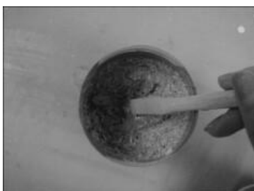
Рис. 3. Смешивание опилки со шликером
