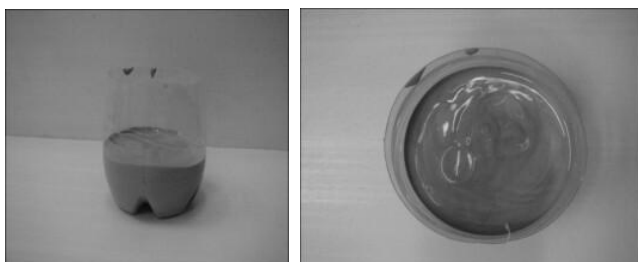
Рис. 1. Заготовка шликера (процеженная глина в жидком состоянии)
