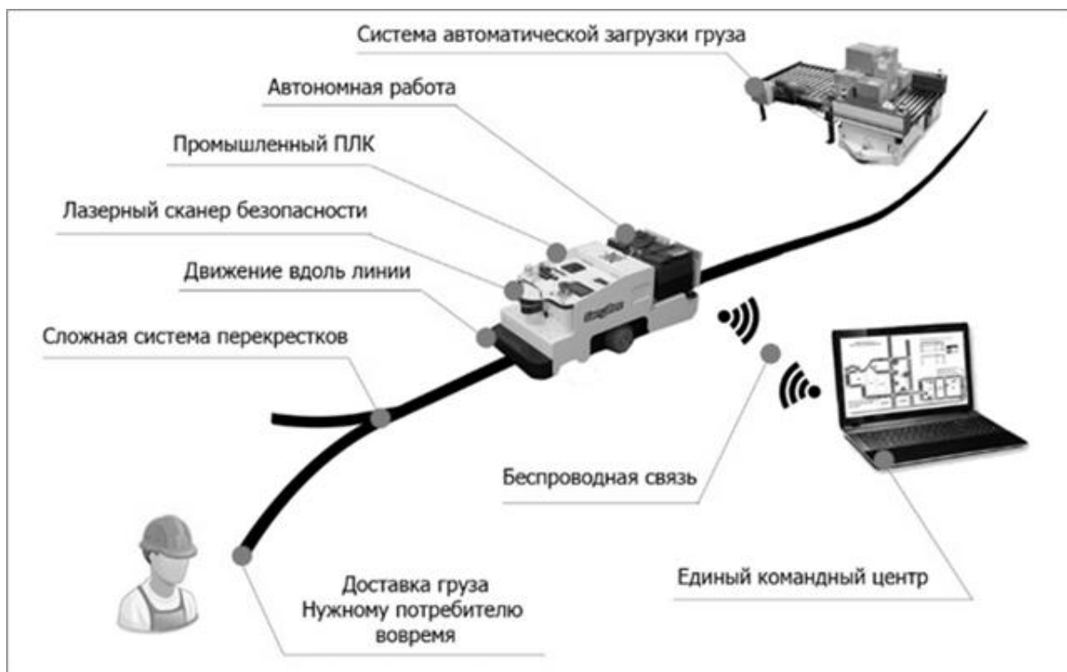
Рис. 1. Принцип работы роботизированных транспортных систем
