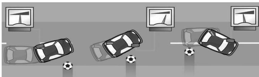
*Рис. 5. Подтормаживание отдельных колес*
