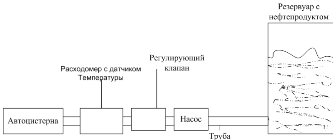
Рис. 1. Технологическая схема процесса налива нефтепродуктов
