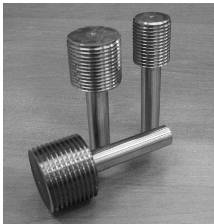
Рис. 5. Деформирующие метчики для трубных резьб
