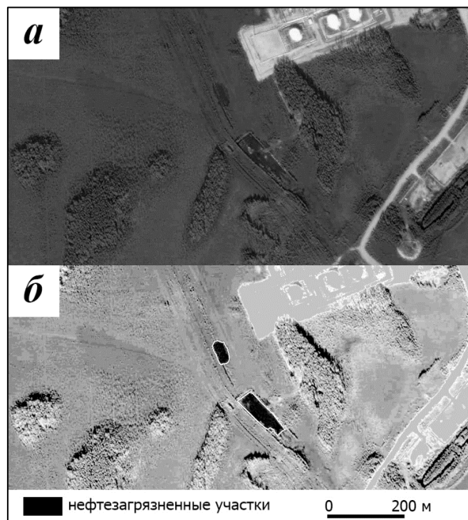
Рис. 2. Дешифрирование нефтезагрязненных земель на космическом снимке GeoEye-1 в программном комплексе ScanEx Image Processor (Кусков А.П., 2017) а – исходный снимок; б – обработанный снимок
