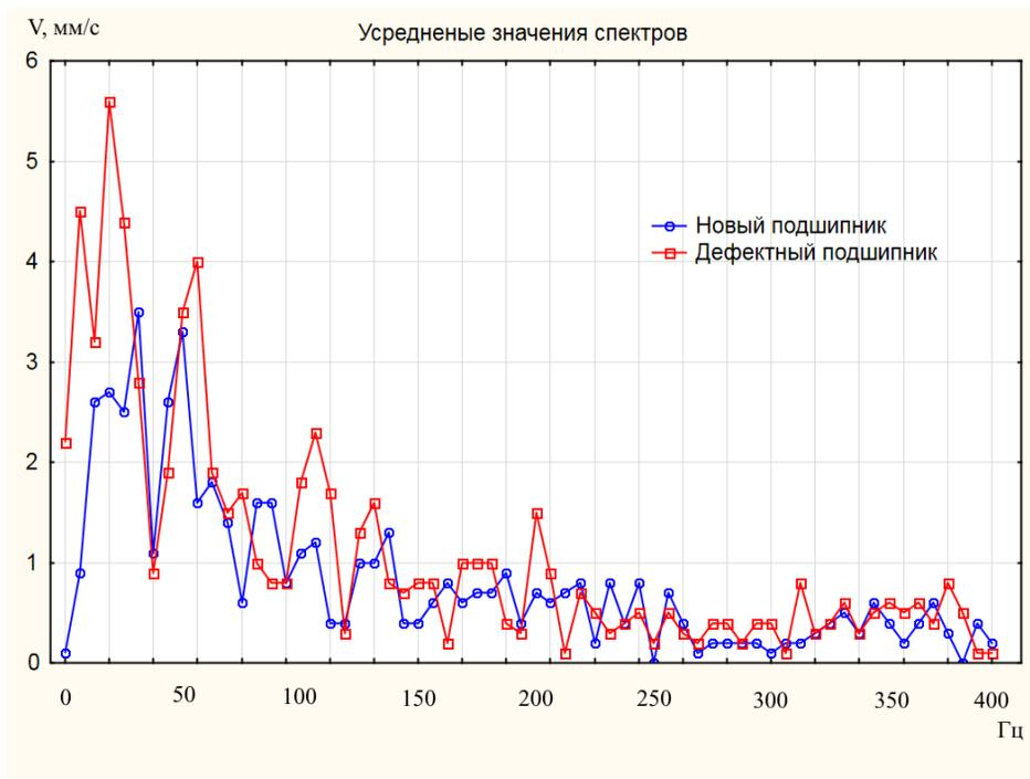
Рис. 4. Зависимость усредненных значений спектров вибрации подшипников от технического состояния
