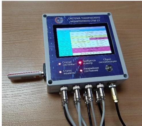
Рис. 2. Измерительный прибор STM-12Т для анализа вибраций
