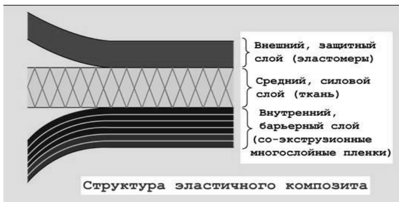
Рис. 2. Пример конструкции стойкого к нефтепродуктам многослойного тканепленочного полимерного материала
