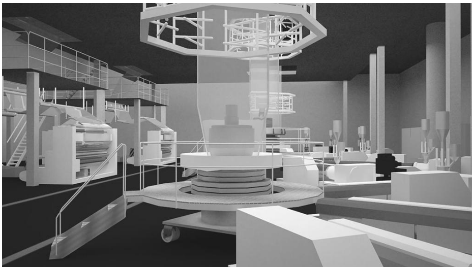
Рис. 3. Трехмерная модель линии выдувной экструзии
