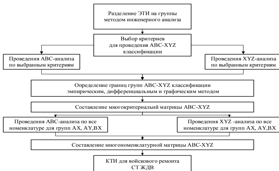
Рис. 3. Алгоритм метода ABC классификации элементов КТИ
