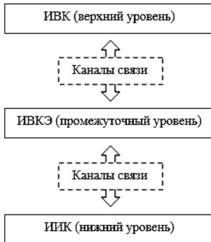
Рис. 1. Трехуровневая архитектура современной АСКУЭ
