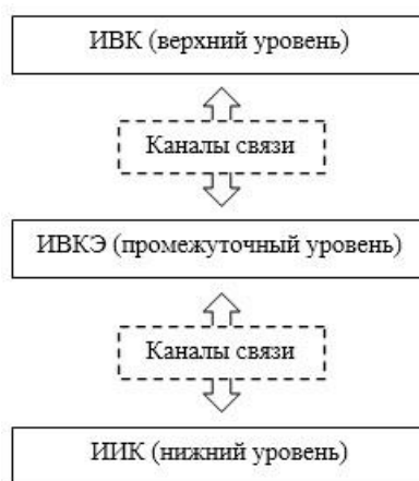
Рис. 1. Трехуровневая архитектура современной АСКУЭ
