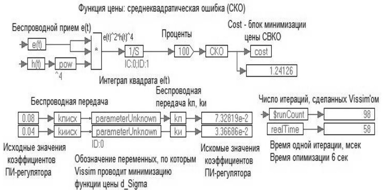
Рис. 4. Фрагмент модели VisSim для оптимизации параметров ПИ-регулятора САР
