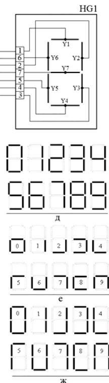
Цифровой формат (д) и цифровые знаки 7-сегментного формата (е), 4-сегментного формата из нижних элементов 7-сегментного формата, 6-сегментного формата, без среднего горизонтального сегмента 7-сегментного формата (ж)
