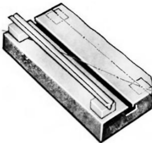
Рис. 3. Схема проверки плоскостности рабочей поверхности стола
