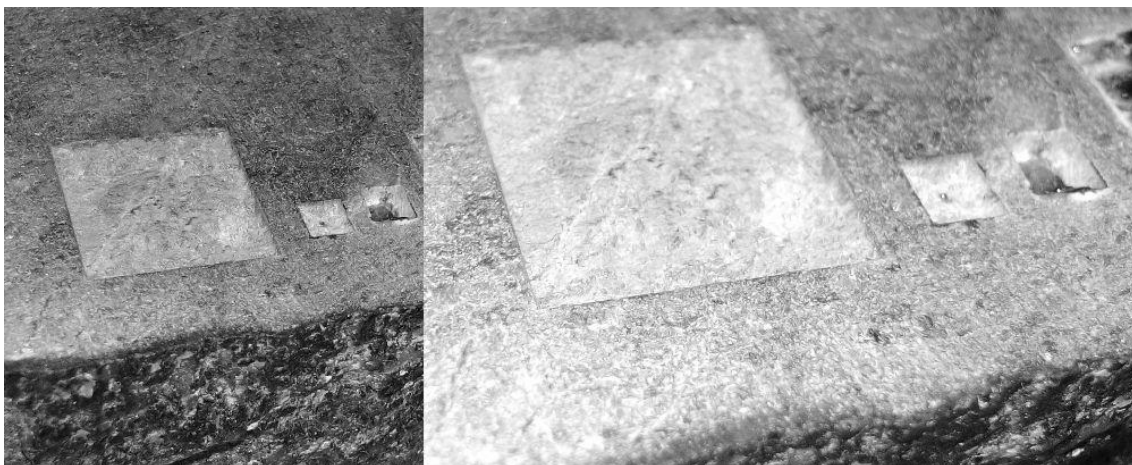
Рис. 3. Образец породы после воздействия лазера с частотой импульса 100 кГц
