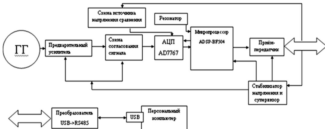
Рис. 1. Структурная схема устройства преобразования и передачи информации, получаемой с гидроакустического преобразователя
