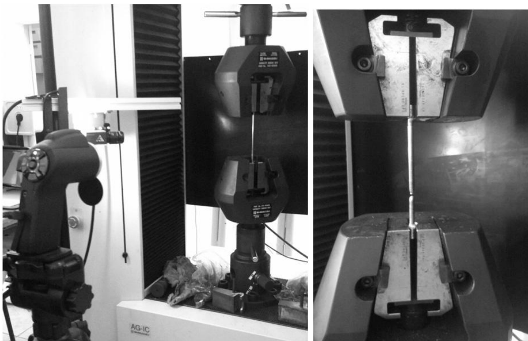
Рис. 4. Образцы из болтов М20, М24, М30. Испытание на растяжение на машине Shimadzuag 300кН
