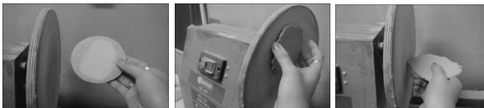
Рис. 5. Процесс формирования с помощью шлифования
