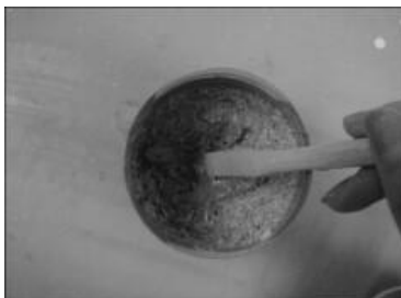
Рис. 3. Смешивание опилки со шликером
