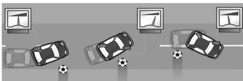
Рис. 5. Подтормаживание отдельных колес
