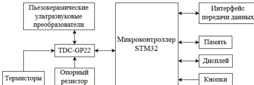
Рис. 2. Структурная схема рассматриваемого расходомера
