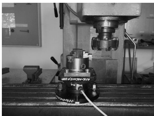
Рис. 2. Экспериментальная установка: а – общий вид; б - динамометр трехкомпонентный М30-3-6к; в - индукционный датчик приближения XS4-P12AB110
