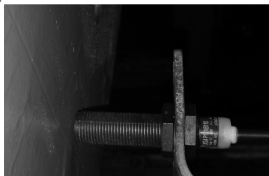
Рис. 2. Экспериментальная установка: а – общий вид; б - динамометр трехкомпонентный М30-3-6к; в - индукционный датчик приближения XS4-P12AB110
