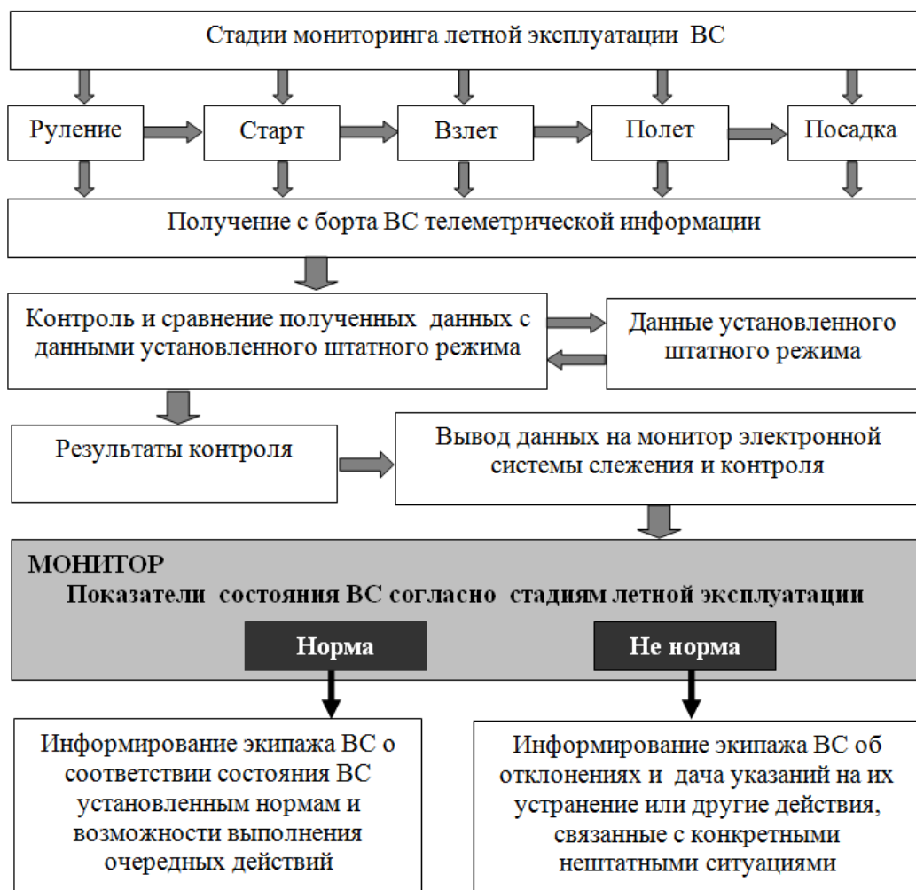
Рис. 1. Принципиальная схема электронной системы слежения и контроля стадий летной эксплуатации ВС службы ОВД
