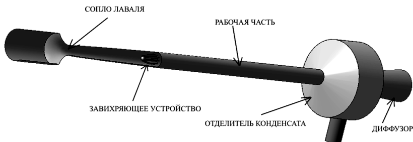
Рис. 1. Устройство сверхзвукового сепаратора
