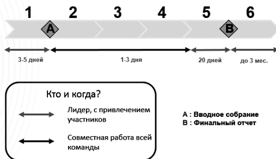
Рис. 1. Структура Kaizen blitz. 1. Подготовка к КВ, определение целей, 2. Обучение, анализ текущей ситуации, 3. Разработка предложений по улучшению, 4. Внедрение улучшений, 5. Стабилизация процесса, 6. Внедрение улучшений с долгим сроком внедрения
