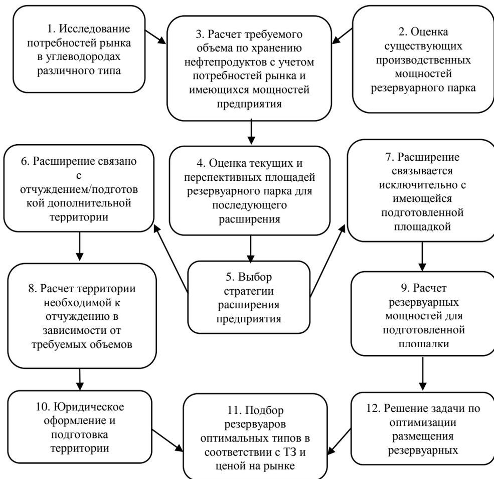
Рис. 1. Алгоритм решения технико-экономической задачи по расширению мощности резервуарного парка
