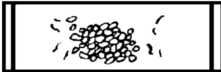
Рис. 3. Пример адгезионного износа
