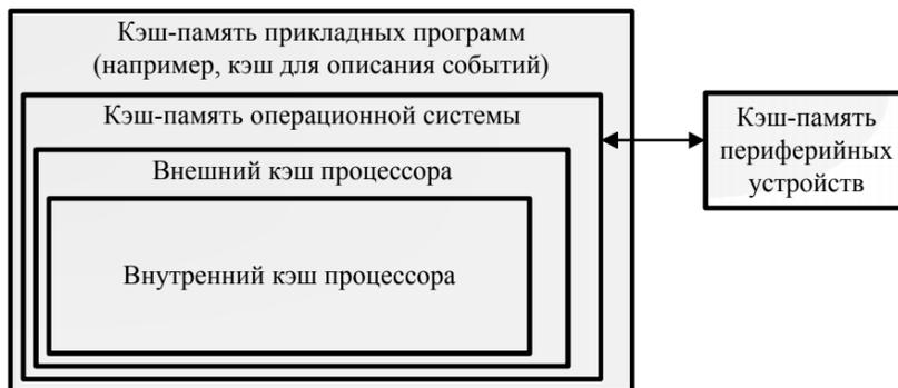
Рис. 2. Структура кэш-памяти вычислительной системы
