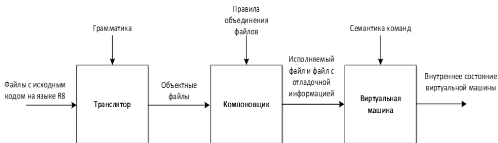
Рис. 1. Схема взаимодействия функциональных блоков
