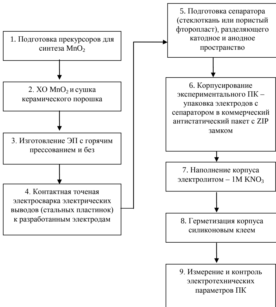
Рис. 3. Технологический маршрут изготовления ПК–ХО–ГП и ПК–ХО–БГП
