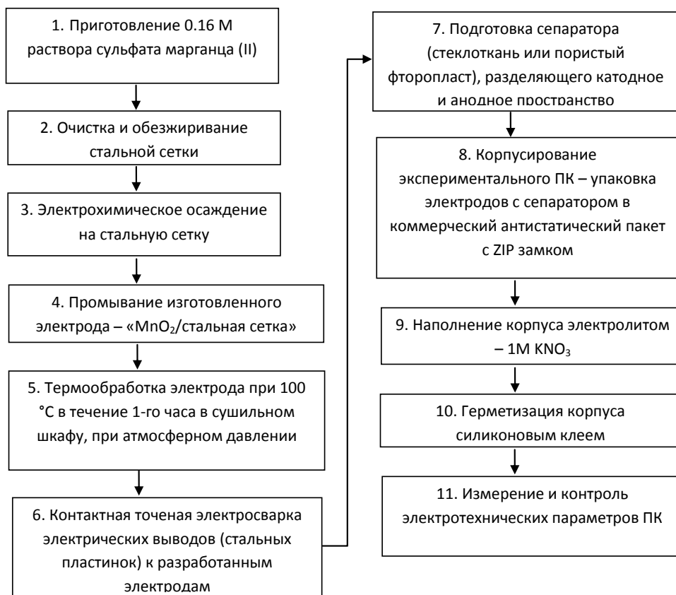
Рис. 2. Технологический маршрут изготовления ПК–ЭО
