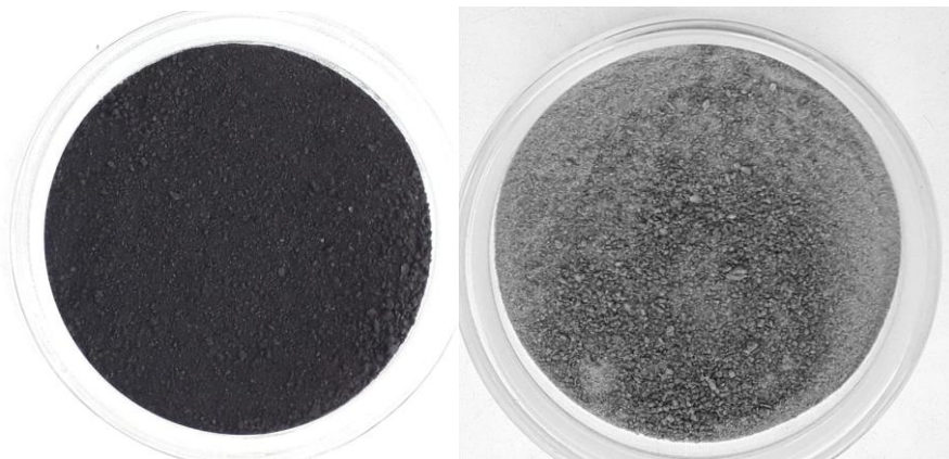
Рис. 4. Гумусовые кислоты в сухом виде, выделенные из удобрения (слева и справа – соответственно концентраты гуминовой и фульвовой кислот)
