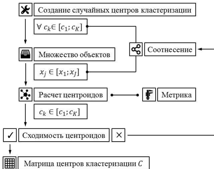
Рис. 2. Схема реализации алгоритма четкой кластеризации c -средних
