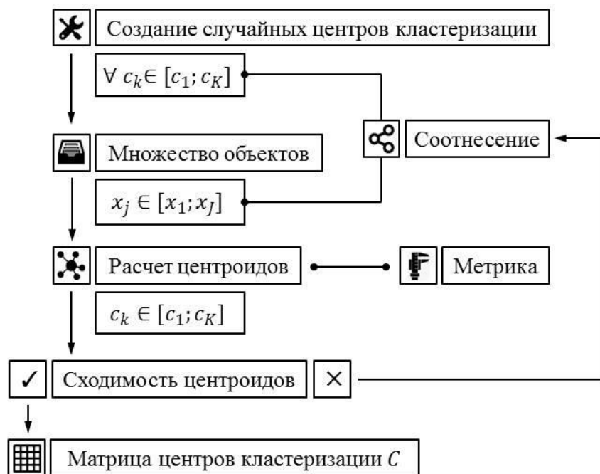
Рис. 2. Схема реализации алгоритма четкой кластеризации c -средних
