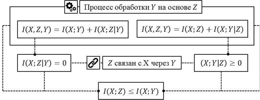
Рис. 5. Алгоритм определения общего количества информации после обработки данных дискретного информационного источника
