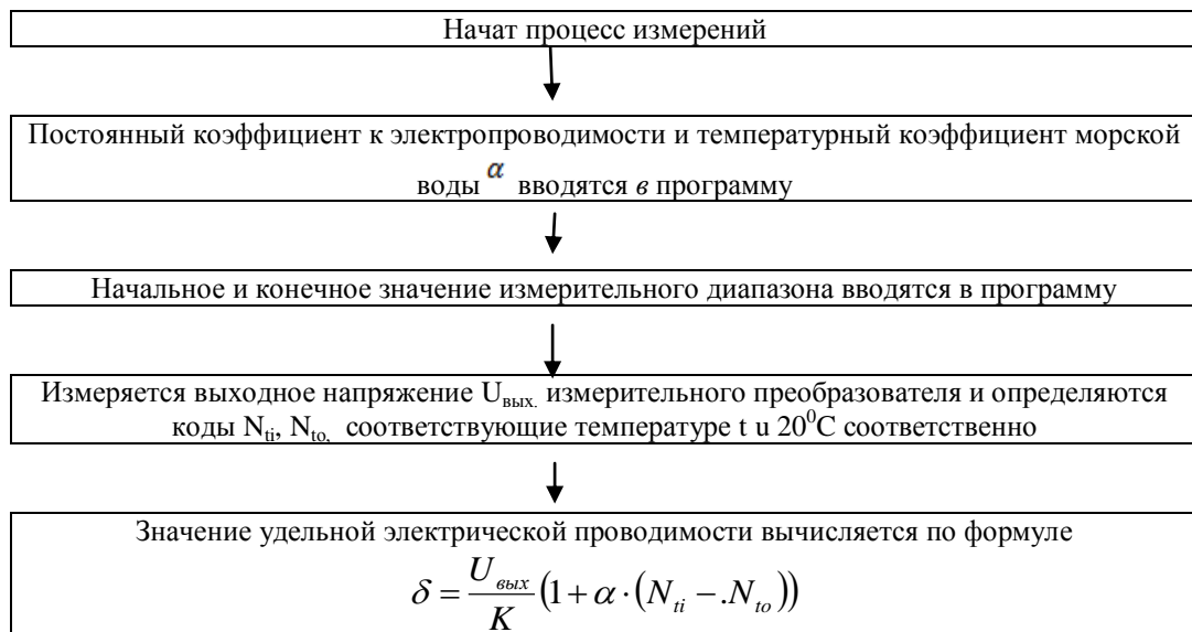
Рис. 2. Алгоритм измерения удельной электрической проводимости с двухэлектродной ячейкой
