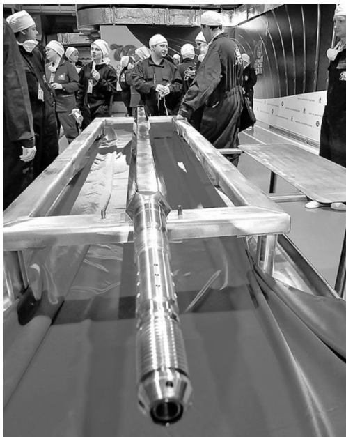
Рис. 2. ТВС с МОКС-топливом для реакторов БН, произведенная на Горно-химическом комбинате в Железногорске
