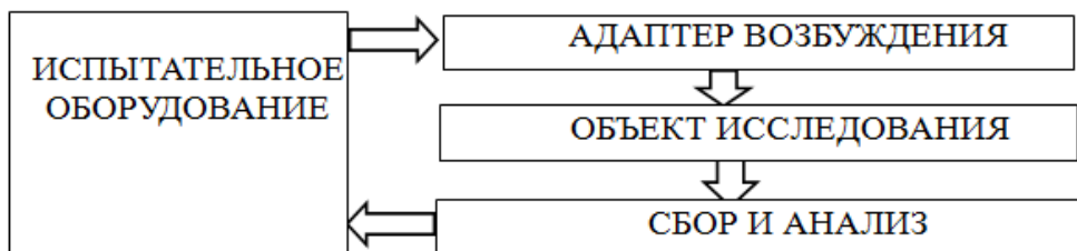
Рис. 1. Общий принцип работы оборудования для проверки неисправностей цифровых электронных модулей
