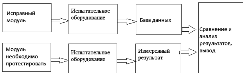
Рис. 7. Схема проверки параметров без источника питания
