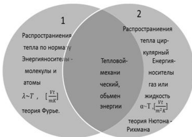
Рис. 1. Диаграмма теплообменов. 1. Теплопроводность. 2. Конвективный теплообмен
