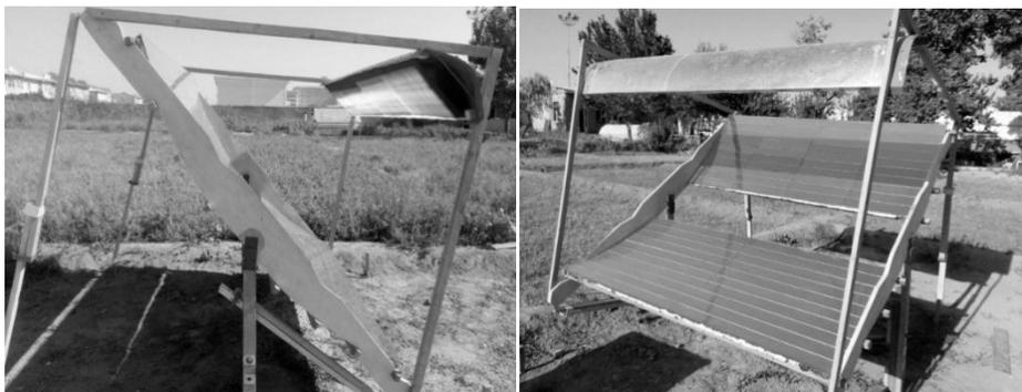
*Рис. 2. Внешний вид параболического концентратора*
