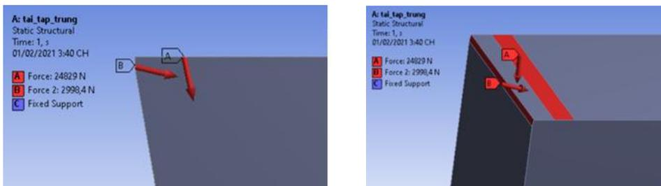
Рис. 1. Сосредоточенная нагрузка действует на передней и задней части
