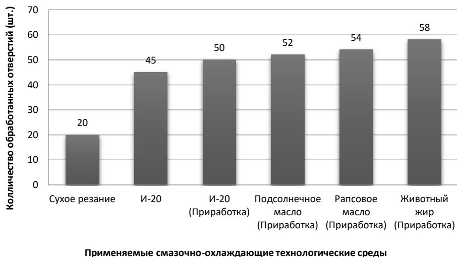
Рис. 4. График стойкости режущего инструмента из быстрорежущей стали P6M5K5 после приработки в среде экологически чистых СОТС. Режимы резания: V_{пр.} = 10 м/мин; V_{стат.} = 30 м/мин; S = 0,1 мм/об. Расход СОТС: 4,5 мл/мин.
