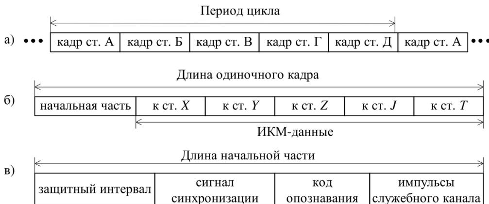
Рис. 2. Кодовая структура цикла передачи в режиме МДВР
