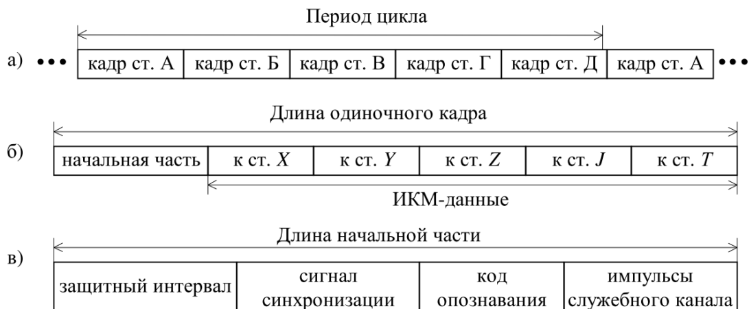
Рис. 2. Кодовая структура цикла передачи в режиме МДВР
