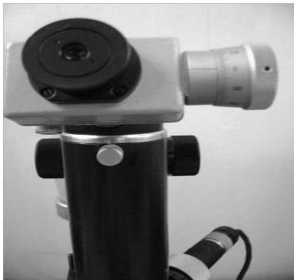
Рис. 11. Винтовой окулярный микрометр
