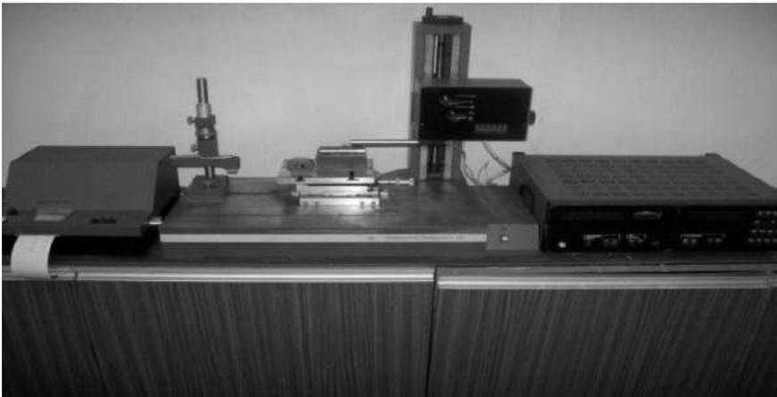
Рис. 7. Профилограф-профилометр модель 250
