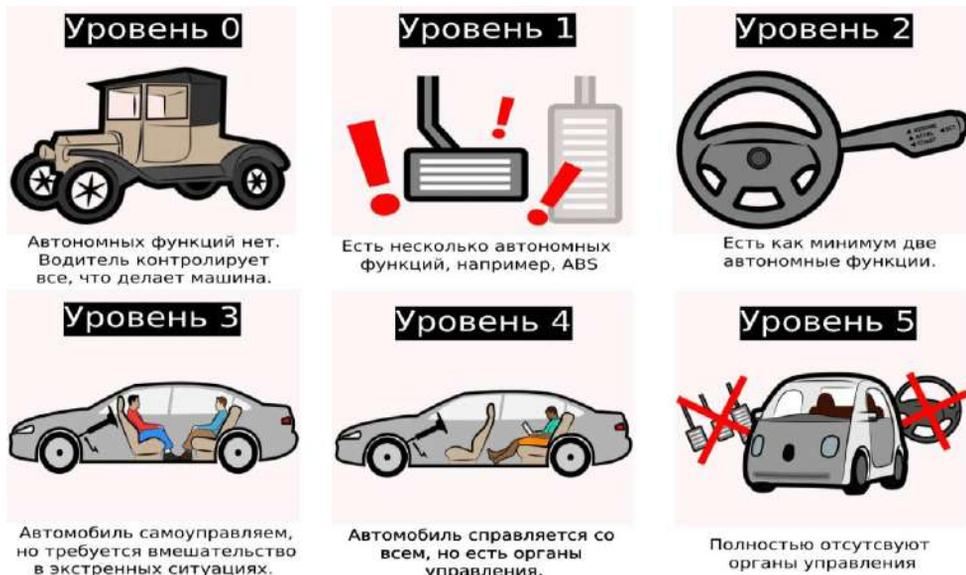
Рис. 1. Таксономия уровней автоматизации согласно SAE
