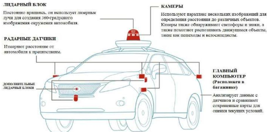
Рис. 3. Принцип работы современного беспилотного автомобиля
