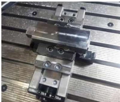
Рис. 7. Заготовка С45 размером 130x50x30 мм
