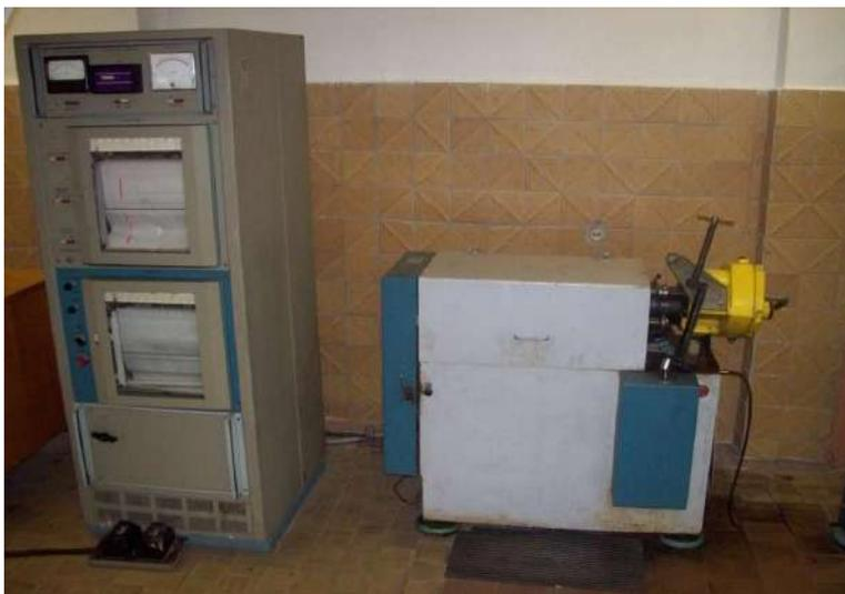
Рис. 3. Триботехнический комплекс на базе машины трения 2070 СМТ-1
