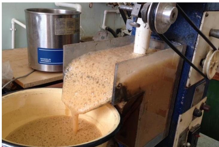
Рис. 2. Процесс работы на флотационной машине ФЛ 240-А.
